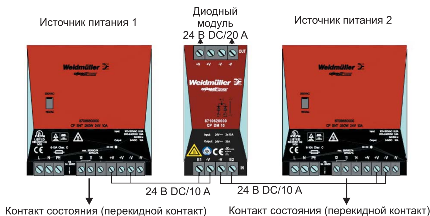
● Рис. 3. Схема подключения диодного модуля ECOLINE
