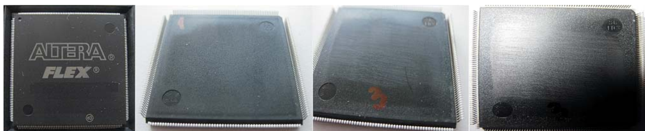
● Рис. 4. Контрафактные интегральные микросхемы Altera Flex
